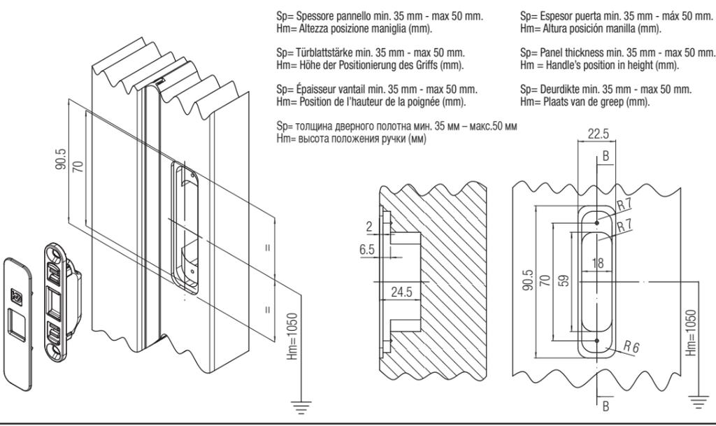
Sp= Spessore pannello min. 35 mm - max 50 mm.
