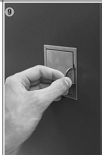
\*Per azionare lo sgancio di sicurezza, inserire una moneta (o coltello/utensile sottile per spessori elevati e serratura decentrata) nella fessura ricavata sulla maniglia senza serratura.
